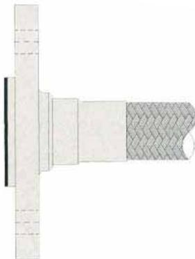
Extremo encapsulado en teflón que impide que el fluido entre en contacto con el acero de la conexión, fabricado en acero inoxidable AISI 316 y teflón.
