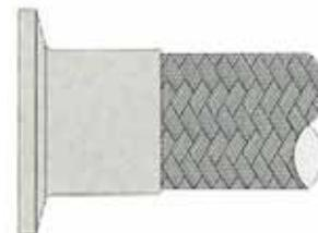
Extremo tipo clamp, crimpado, el fluido entra en contacto con el acero de la conexión, fabricado en acero inoxidable AISI 316.
