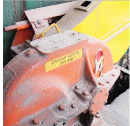
Aceite Multigrado para lubricación de cajas de engranajes
