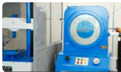
Equipo de ensayos universales. Prueba de torque, tensión y compresión
