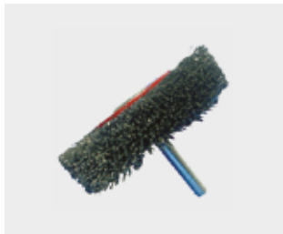
Art. 714 69 020 70mm X 18mm X 6mm Cepillo metálico circular para altas rotaciones 15,000rpm
