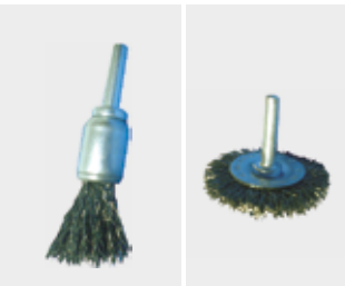
Art. 714 69 024 Cepillo metálico tipo pincel para bajas rotaciones 4,500rpm 25mm X 6mm
